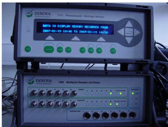
*Dysfonctionnement déjà observé* : Lorsque le programme indique qu'il purge, les diodes de la voie 6 dosage et de waste air sont allumées. Cela indique que la purge ne s'effectue pas correctement.
